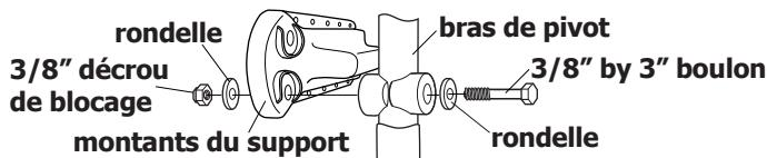
Après les avoir joint, incliner les montants en position verticale.
