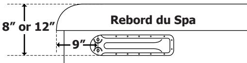
En fixant les montants du support à 8 po du rebord du spa et à 9 po du coin du spa (voir dessin), un dégagement de 9 po derrière le spa sera nécessaire. Environ 75% du couvercle du spa sera au-dessus du spa dans la position de rangement. En fixant les montants du support à 12 po du rebord du spa et à 9 po du coin du spa, un dégagement de 15 po derrière le spa sera nécessaire. Et environ 50% du couvercle du spa sera au-dessus du spa dans la position de rangement.
